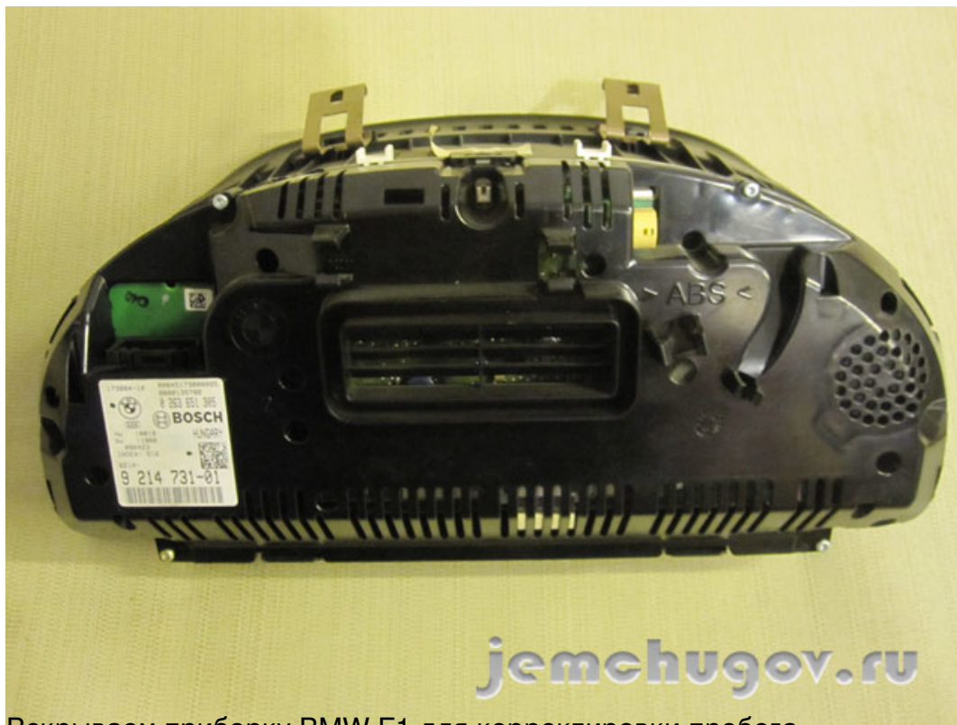
Вскрываем приборку BMW F1 для корректировки пробега
