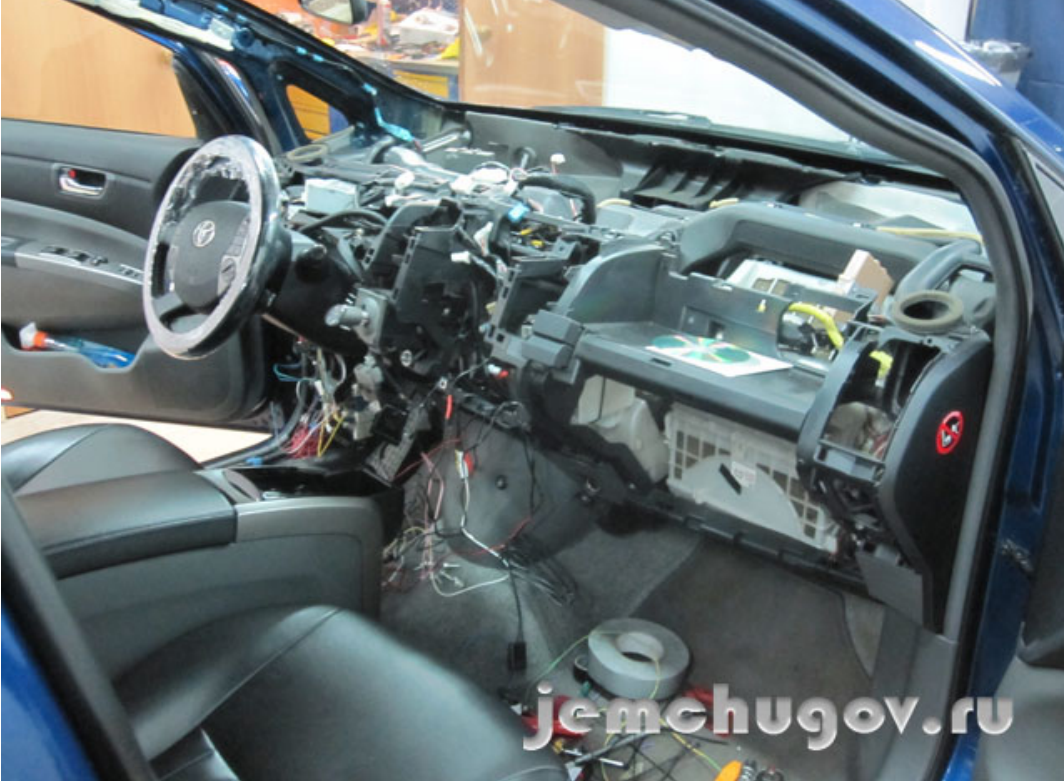
Для защиты от угона устанавливается система с уникальным блоком управления двигателя
