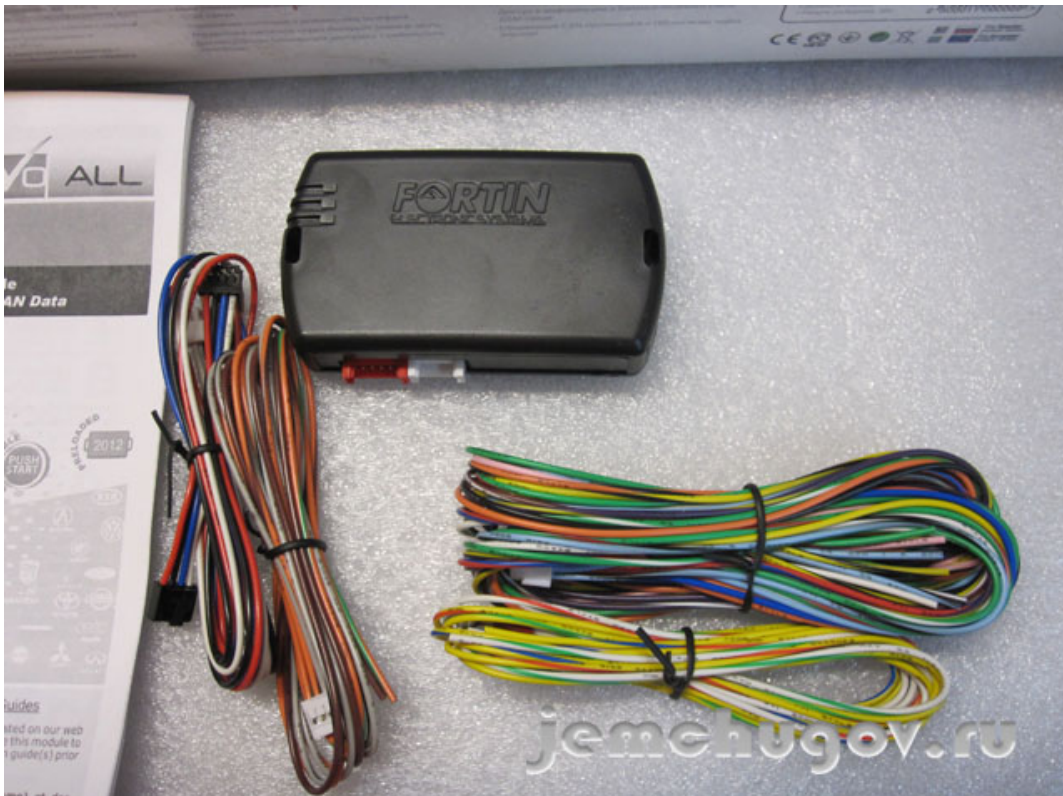
Подготовка жгутов сигнализации к установке
