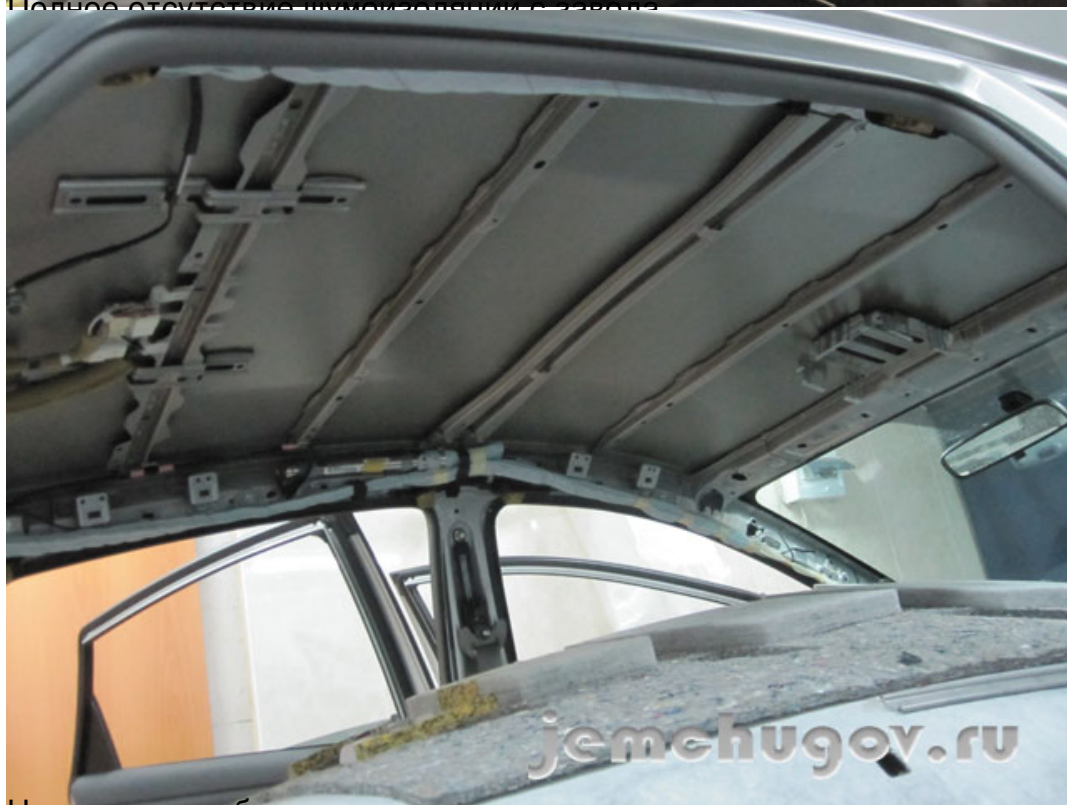
Наклеиваем вибропласт на потолок
