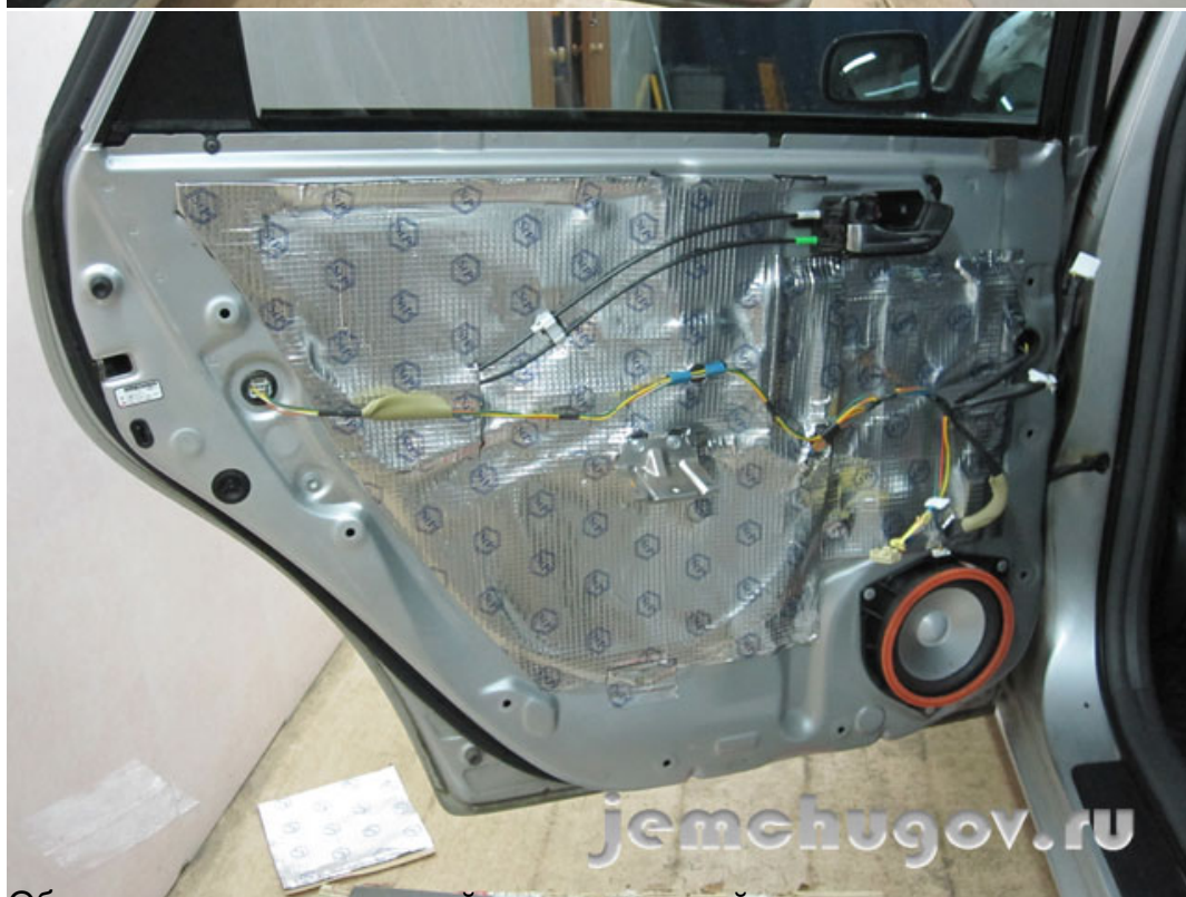
Обшивка двери с заводской шумоизоляцией
