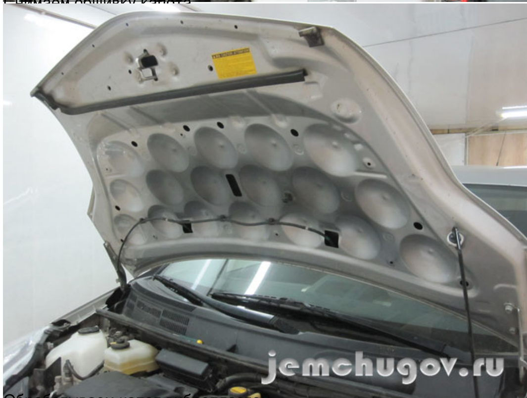
Обработываем капот вибропластом
