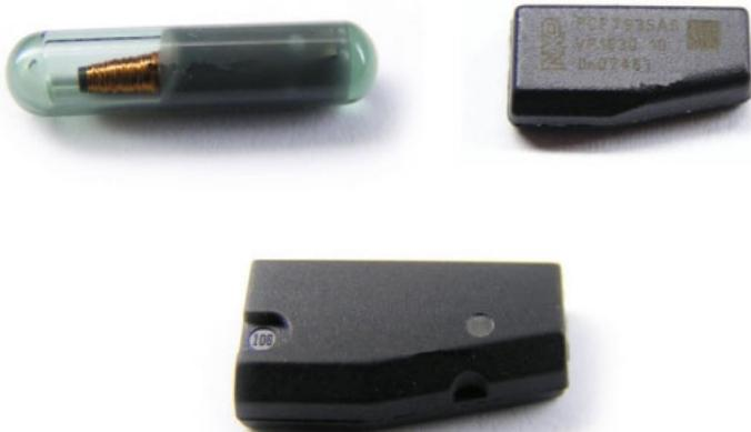
В замок зажигания встроена антенна, которая мгновенно считывает код транспондера, когда вставляется ключ.
