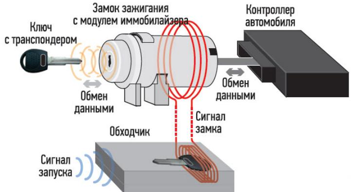
Для осуществления автозапуска двигателя с автосигнализации требуется ключ или его транспондер, который кладется в обходчик иммобилайзера. Обходчик иммобилайзера включается на время работы автозапуска и, таким образом, происходит эмуляция ключа в замке зажигания.
